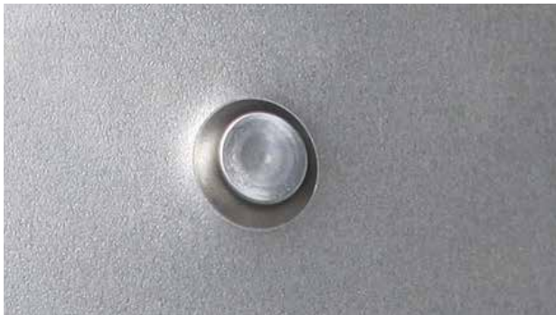
REZULTAT OSADZENIA NITU SAMOWIERCĄCEGO
