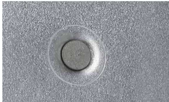
REZULTAT OSADZENIA NITU SAMOWIERCĄCEGO
