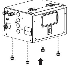
Les Silent bloc sont livrés dans un sachet avec le dévidoir Silent blocks are delivered in a bag with the wire feeder
