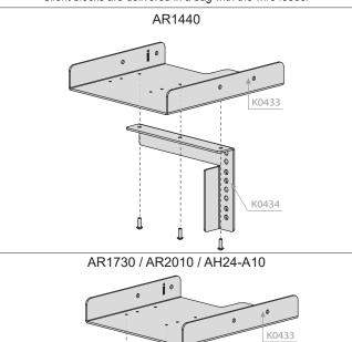
M5x16 (x3) La position de l'équerre dépend du type de robot The position of the bracket depends on the type of robot
