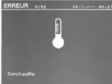
La protección térmica se realiza mediante una termistancia sobre el puente rectificador que bloquea el uso de la máquina con el mensaje "sobrecalentamiento"
