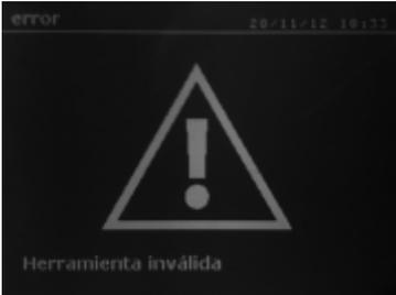
El mensaje « Herramienta no válida » aparece al encender la máquina y avisa al usuario que un botón o gatillo queda accionado, o que se detecta un corto circuito permanente. Comprobar el gatillo de la pistola y los botones sobre la o las pinzas para hacer desaparecer este mensaje.
