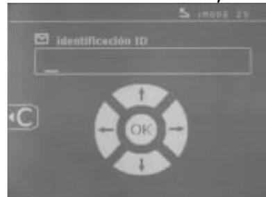
Las teclas 'izquierda' y 'derecha' permiten desplazar el cursor en el campo. Las teclas de arriba y abajo permiten cambiar las letras o cifras. Una breve presión en la tecla Esc permite suprimir el campo. La tecla Modo permite la navegación de campos para modificar o leer.
