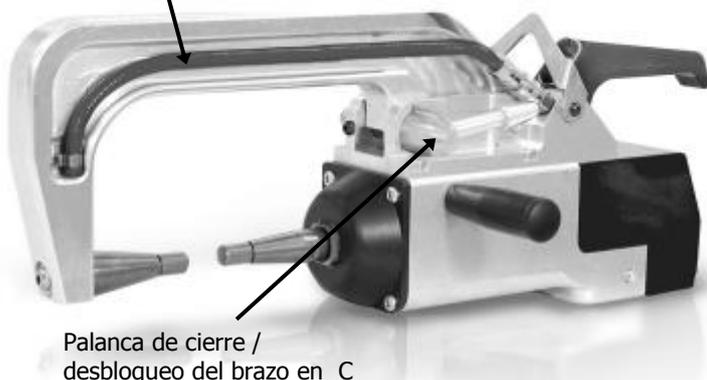
Palanca de cierre / desbloqueo del brazo en C
