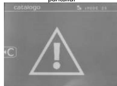
Al aparecer el triangulo, una segunda presión en la tecla
