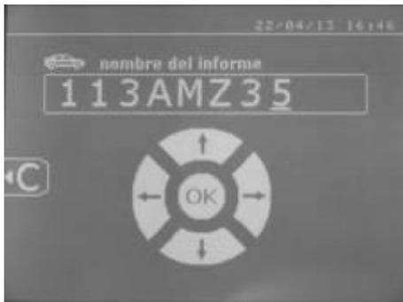
Memorizar un informe permite recuperar los datos de una serie de puntos realizados con la pinza, y recordarlos en la tarjeta SD para que puedan ser transferidos desde un ordenador por ejemplo.
