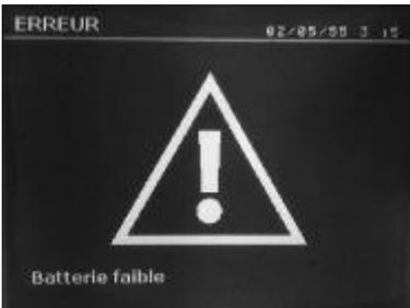
El mensaje « Bateria débil » aparece al encender la máquina y avisa al usuario que la batería de la tarjeta de mando está débil. Esta pila asegura la salvaguardia de la fecha y hora al apagar el equipo.
