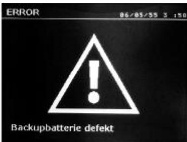
Die Meldung „Backupbatterie defekt“ erscheint wenn die Anlage eingeschaltet wird und weist den Anwender darauf hin, dass die Spannung der Batterie auf der Steuerkarte schwach ist. Diese Batterie sichert die Speicherung des Datums und der Uhrzeit wenn die Anlage ausgeschaltet wird.
