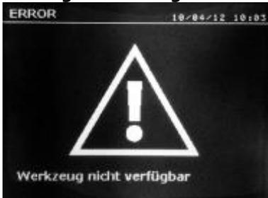
Die Meldung „Werkzeug nicht verfügbar“ erscheint wenn die Anlage eingeschaltet wird und weist den Anwender darauf hin, dass ein Knopf oder Taster noch aktiv ist oder ein permanenter Kurzschluss ermittelt wurde. Kontrollieren Sie den Auslöser der Pistole und die Knöpfe auf der oder den Zange(n), um diese Fehlermeldung zu beheben.
