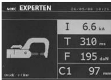
Die hier vorgeschlagenen Parameter sind analog zu den im «STANDARD» Modus automatisch gewählten Einstellungen- angefangen mit dem Schweißstrom.
