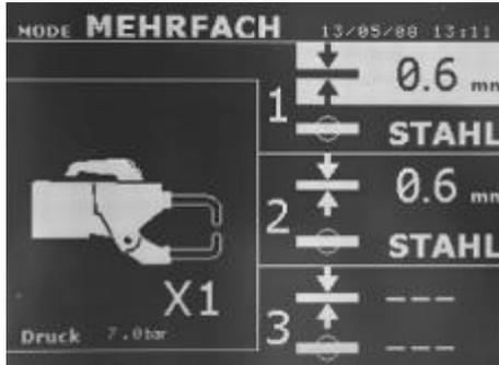
In diesem Modus wählen Sie Blechstärke und Blechtyp für jedes Blech einer Zwei- oder Mehrfachkombination separat durch Auswahl von:
