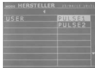
Zusätzlich ermöglicht dieser Modus den Abruf zuvor vom Anwender mittels der „Gyspot-Software“ erstellter Parametersätze. Die „Gyspot-Software“ befindet sich auf der mit der Maschine gelieferten SD-Karte und beinhaltet eine Onlinehilfe zur Bedienung.
