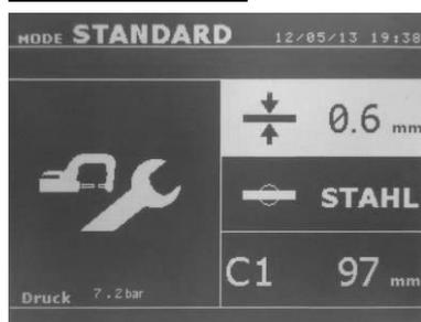
Die Taste wechselt von einem Modus in den nächsten. Im Zangen-Einstellungs-Modus wird die Zange mit dem ausgewählten Anpressdruck, jedoch ohne Strom geschlossen. Sie bleibt geschlossen, solange die Taste **A** der Zange gedrückt bleibt. Dies ermöglicht die Überprüfung und Ausrichtung der Elektrodenkappen und Arme. Zwei sekundiges Drücken der Taste wechselt zurück in den «STANDARD» Modus.
