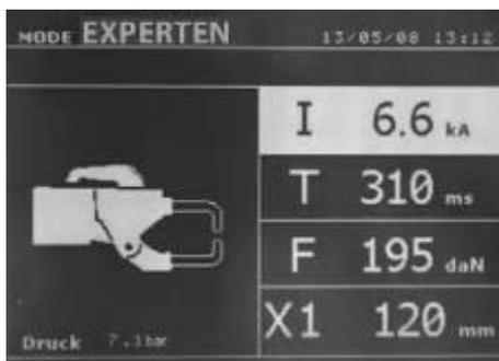
Die hier vorgeschlagenen Parameter sind analog zu den im «STANDARD» Modus automatisch gewählten Einstellungen- angefangen mit dem Schweißstrom.
