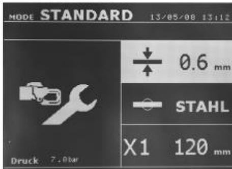
Die Taste wechselt von einem Modus in den nächsten. Im Zangen-Einstellungs-Modus wird die Zange mit dem ausgewählten Anpressdruck, jedoch ohne Strom geschlossen. Sie bleibt geschlossen, solange die Taste **A** der Zange gedrückt bleibt. Dies ermöglicht die Überprüfung und Ausrichtung der Elektrodenkappen und Arme.
