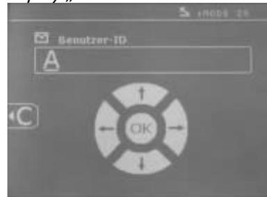
Mit den LINKS und RECHTS Pfeiltasten können Sie den Cursor in das Feld bewegen. Mittels der HOCH und RUNTER Pfeiltasten können Sie die Buchstaben oder die Ziffern ändern. Drücken Sie bitte kurz auf die ESC Taste, um das Feld zu löschen. Die MODE Taste ermöglicht es durch die Felder zu scrollen, um diese zu ändern oder zu lesen.
