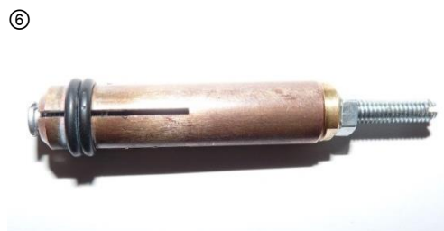
Měděný držák pro svařování svorníků M4 (průměrØ 4 mm)
