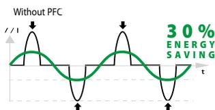
La tecnologia PFC rimuove i picchi e regola la corrente di alimentazione. Favorisce anche l'utilizzo di prolunghe o di gruppi elettrogeni e contribuisce a ottenere una migliore stabilità di corrente a seconda della fase di saldatura.
