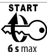
Draai de contactsleutel om, om de schakelaar uit te zetten en de starter functie te activeren (6 s max).
