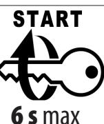
Girare la chiave del veicolo (6 s max), per chiudere il contattore e attivare la funzione avviamento.
