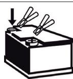
**! ERROR** En caso de inversión de polaridad, el STARTPACK PRO 12.24 XL le indica: Buzzer + led rojo encendido.
