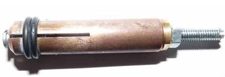
用于焊接M4（直径  $\varnothing 4\text{mm}$ ）螺栓的4槽铜尖端
