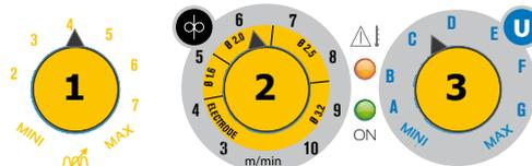
1. Permette di adattare manualmente la **dinamica dell'arco**.
