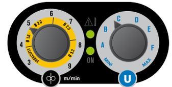
1. Auswahl der Drahtgeschwindigkeit 3 bis 10 m/min (MIG/MAG) bzw. vereinfachte Stromeinstellung bezogen auf den Elektroden Durchmesser (MMA)
