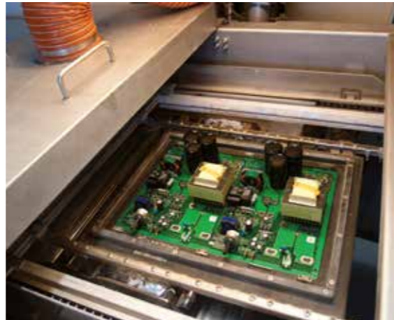
Nouveau robot de soudage pour les cartes électroniques. La carte passe dans un bain d'étain qui permet de souder ses quelque 200 composants en une seule fois.
