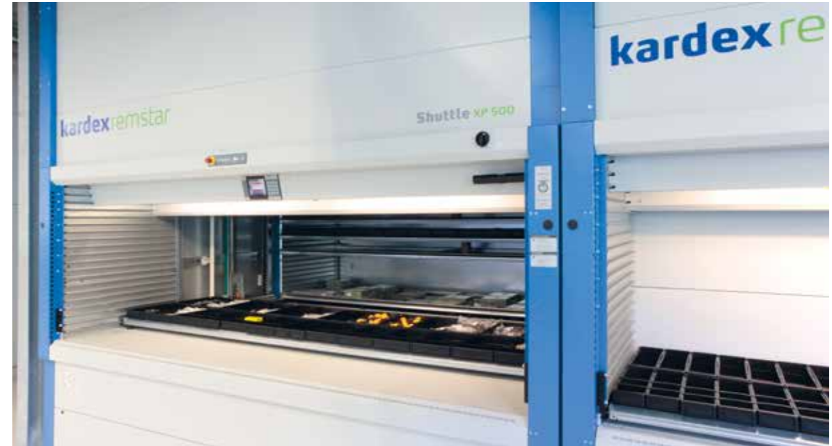
L'entreprise a investi dans des systèmes de stockage Kardex pour les composants des cartes électroniques. Onze millions de composants sont ainsi stockés sur deux niveaux.
