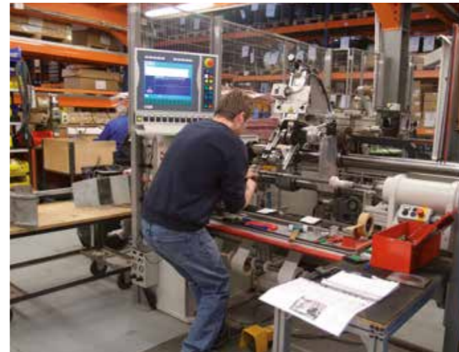
GYS a investi dans un robot de bobinage de forte puissance, permettant la réalisation de 15 000 pièces quotidiennes.
