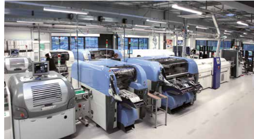
L'assemblage des cartes électroniques est entièrement automatisé.
