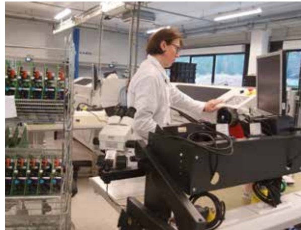
Chaque circuit imprimé est testé individuellement lorsque tous les composants sont implantés.
