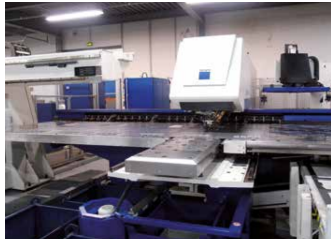
Les machines-robots se saisissent de tôles dans les racks de stockage et les amènent en position de travail. Fentes d'aérations ovales, moulures oblongues, orifice carrés ou ronds, chaque pièce tient compte des spécificités de chaque commande.
